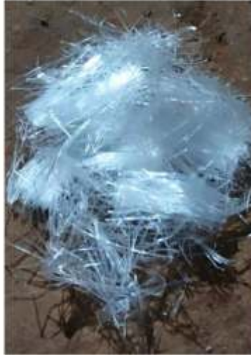
Macro Fibra FIBRASI Dosis típica 0.8-1.6kg x m 3
