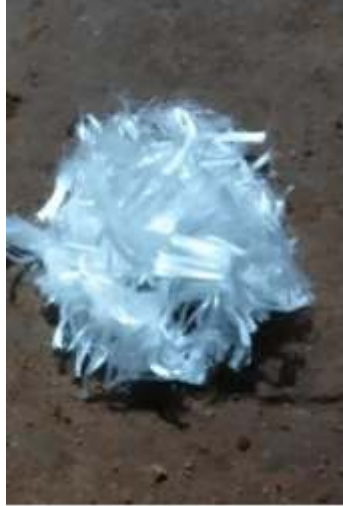
Micro Fibra FIBRASI Dosis típica 0.6 Kg x m 3
