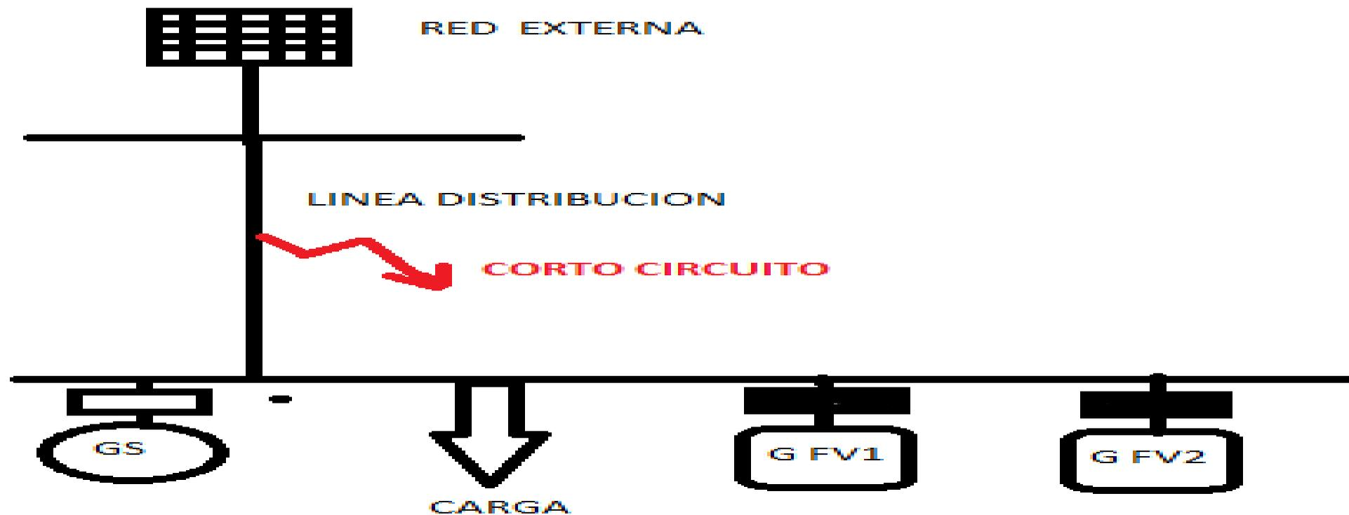
SE MODELA UN CORTOCIRCUITO TRIFASICO CON DURACION DE 120 milisegundos, en la cual actúan las protecciones, quedando la barra de carga con los dos generadores fotovoltaicos todos de igual potencia pero distinta curva de capacidad respecto al generador síncrono, sosteniendo la carga, y sin la red externa hasta el despeje de falla
