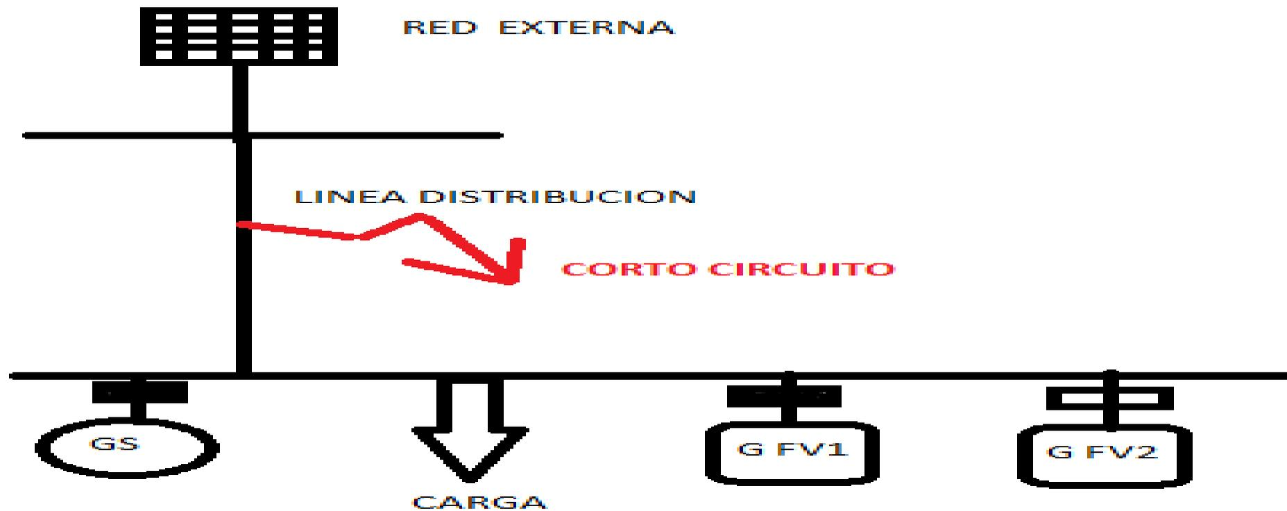
SE MODELA UN CORTOCIRCUITO TRIFASICO CON DURACION DE 120 milisegundos, en la cual actúan las protecciones , quedando la barra de carga con el generador síncrono y el solar fotovoltaico sosteniendo la carga, y sin la red externa hasta el despeje de falla
