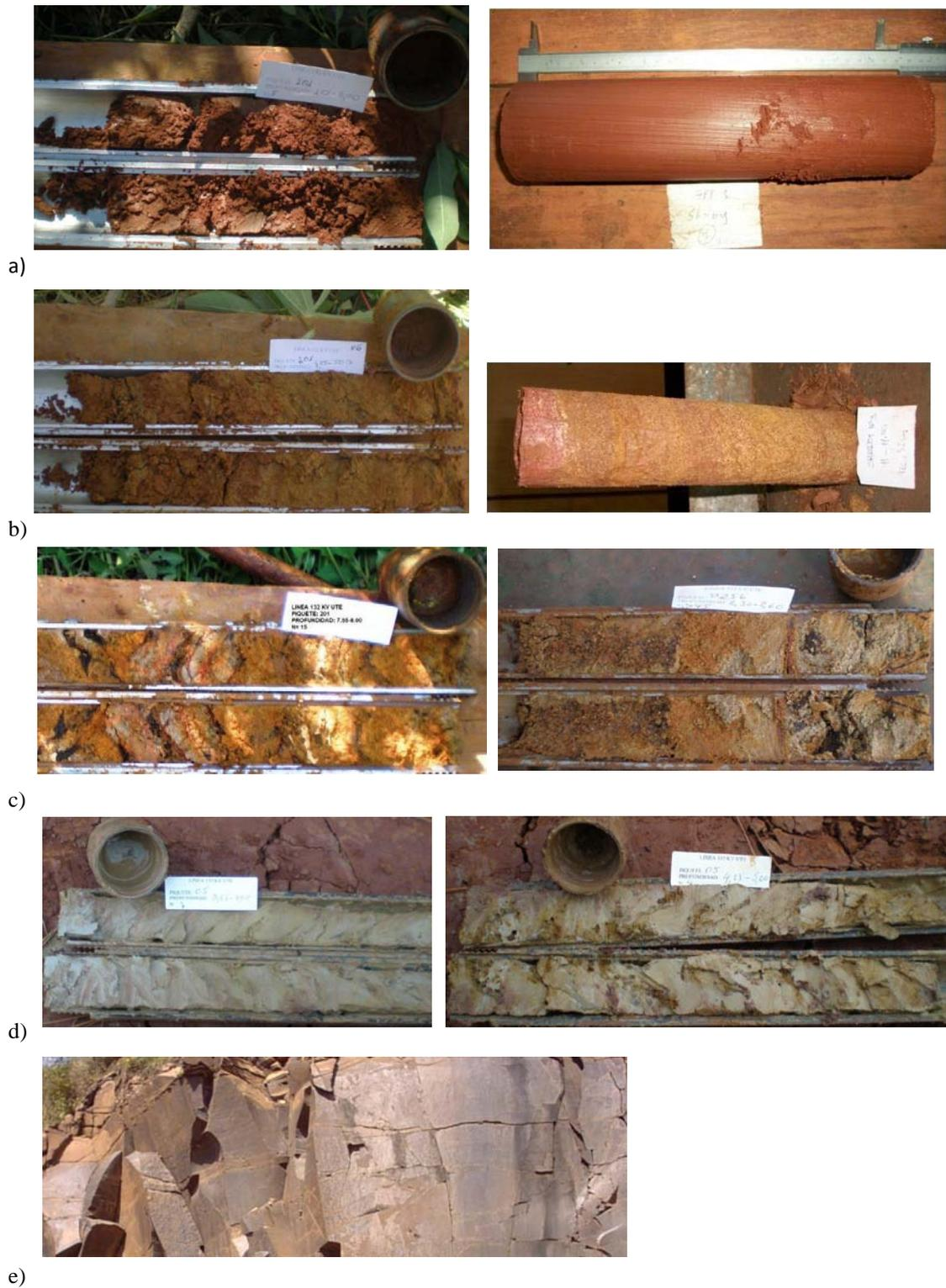
**Figura 3.** Imágenes fotográficas de tipología de suelos detallados: a) Suelos rojos; b) Saprolito; c) Transición Saprolito-Roca; d) Suelos grises (Ñáu); e) Roca Basáltica.
