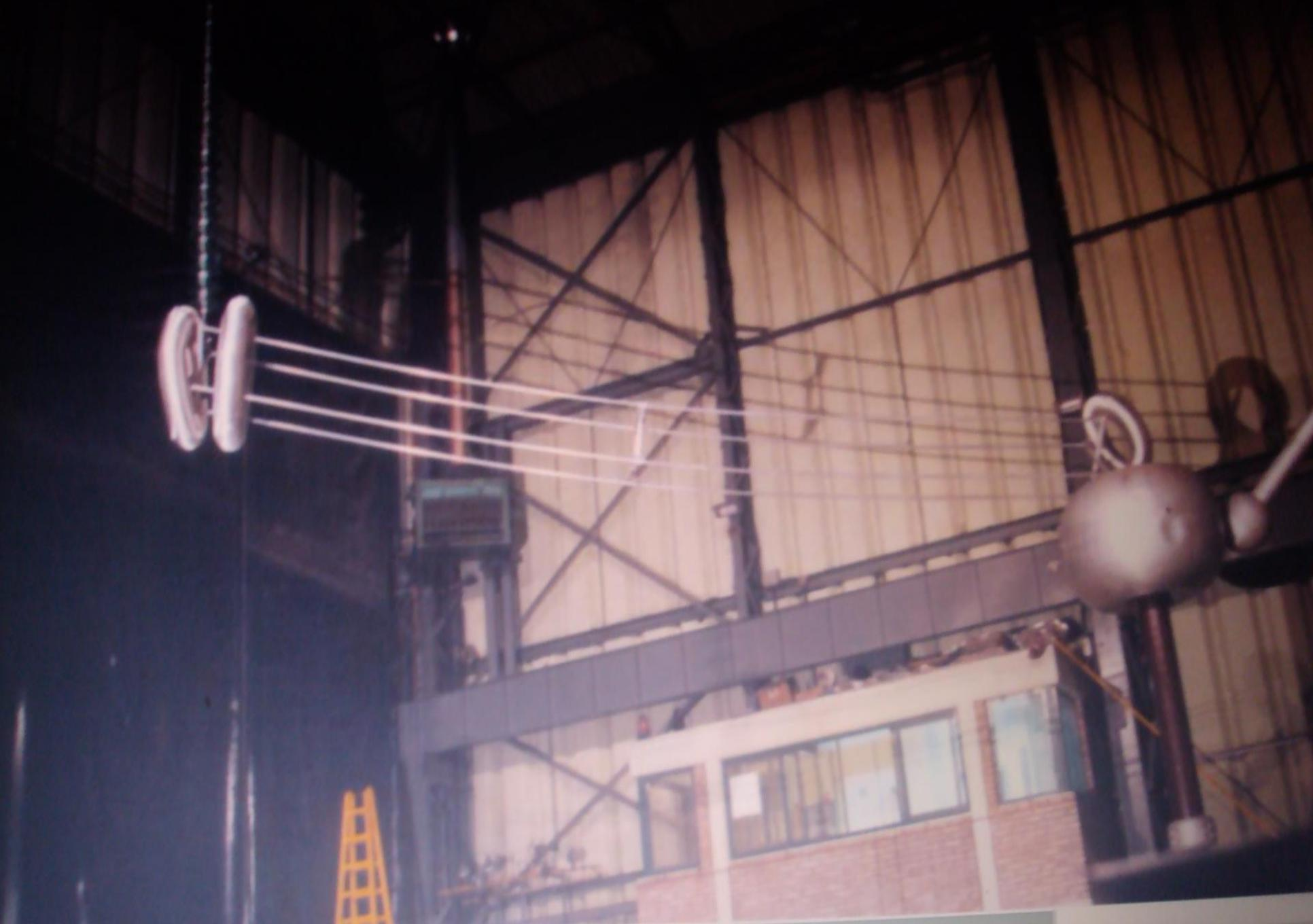
ENSAYO DE LABORATORIO PARA ANALIZAR EL EFECTO CORONA
