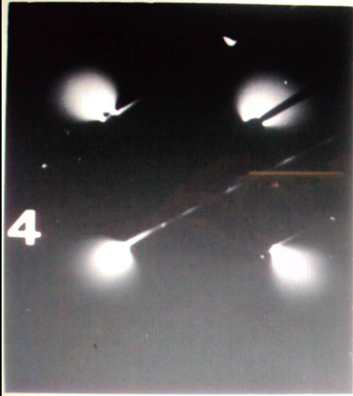
ENSAYO DE LABORATORIO PARA ANALIZAR EL EFECTO CORONA
