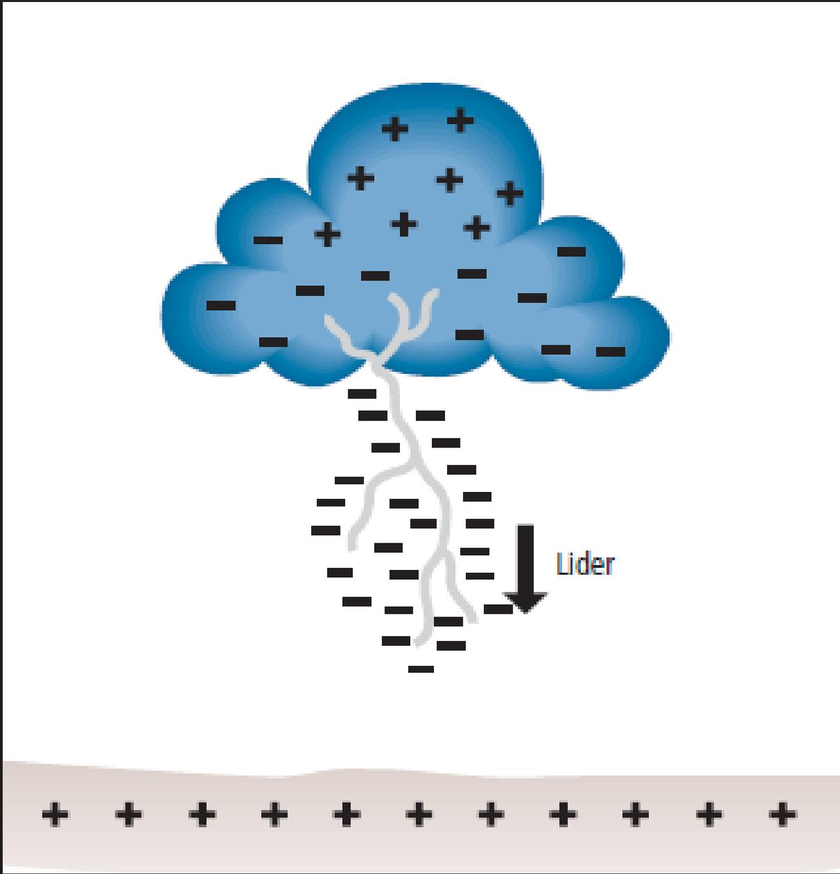
Fig. 2.1.2: Mecanismo de descarga de un rayo descendente negativo (Rayo nube-tierra).
